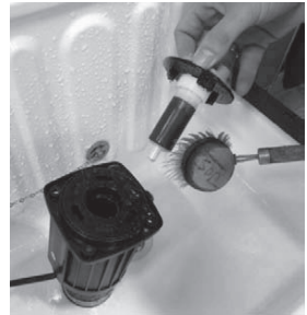
4. Retirez le rotor du carter de pompe et nettoyez le avec de l'eau et une brosse
